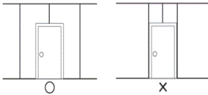
ジョイント部がドア枠や窓枠の延長線上に来ないように
